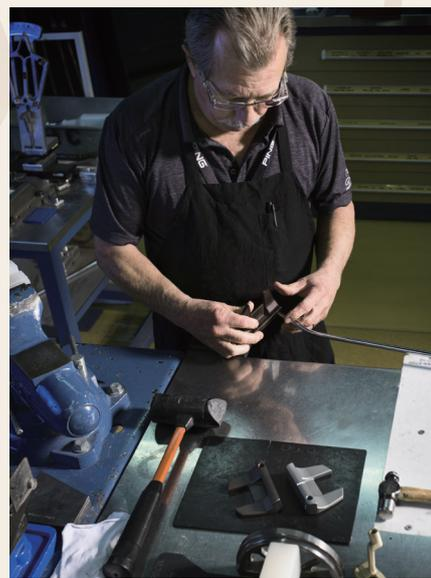
「PLD」シリーズは、完全削り出しのヘッドにこだわり、形状やトップレール、バックフェースなど、細部にわたり1個あたり約4時間以上かけて造られています。また、「PLD MILLED SE」では、グリップやヘッドカバーにもこだわりがあり、その時のモデルに合わせたカラー、デザインを採用しています。今回は、パティナー仕上げのヘッドに合わせたオレンジをアクセントにしたデザインです。
